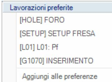
La lista di figura è un esempio: in costruzione di programma è possibile inserire lavorazioni indicate direttamente dall'elenco, senza accedere alla palette delle lavorazioni.
