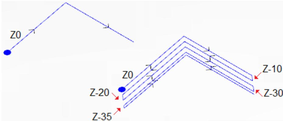
a la izquierda aparece el perfil original, asignado con dos tramos lineales ejecutados en cota de profundidad  $Z=0.0$ .
