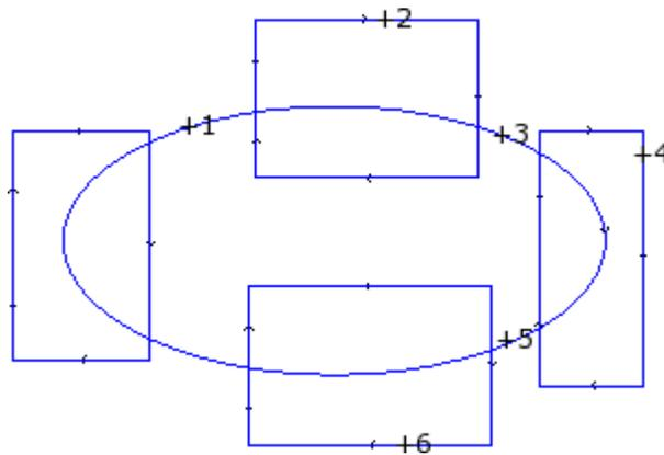
La figura indica un programa formado por perfiles que forman intersecciones. Las 6 cruces localizan las partes indicadas para la construcción del nuevo perfil. Las cruces son enumeradas e indican el orden con el cual las partes seleccionadas son añadidas en el nuevo perfil:
