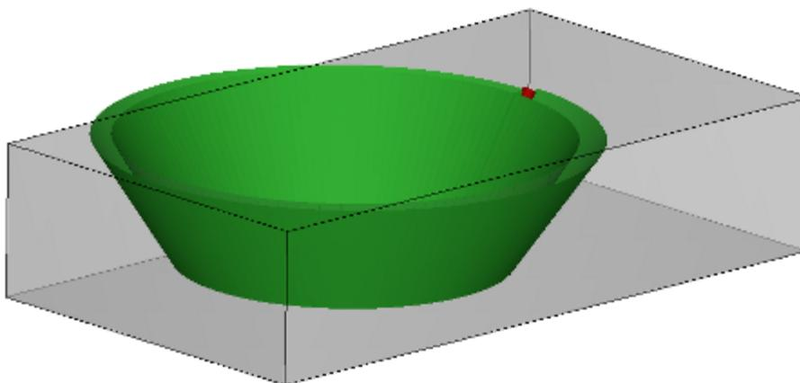
Si la selección **Seguimiento tangente** verifica una orientación de la herramienta perpendicular a la cara, esta misma corresponde a la solicitud de mantener el eje de la herramienta perpendicular durante la ejecución del perfil, también al variar del plano de cara y por analogía con lo dicho aquí en seguida por el caso de un setup vertical.
