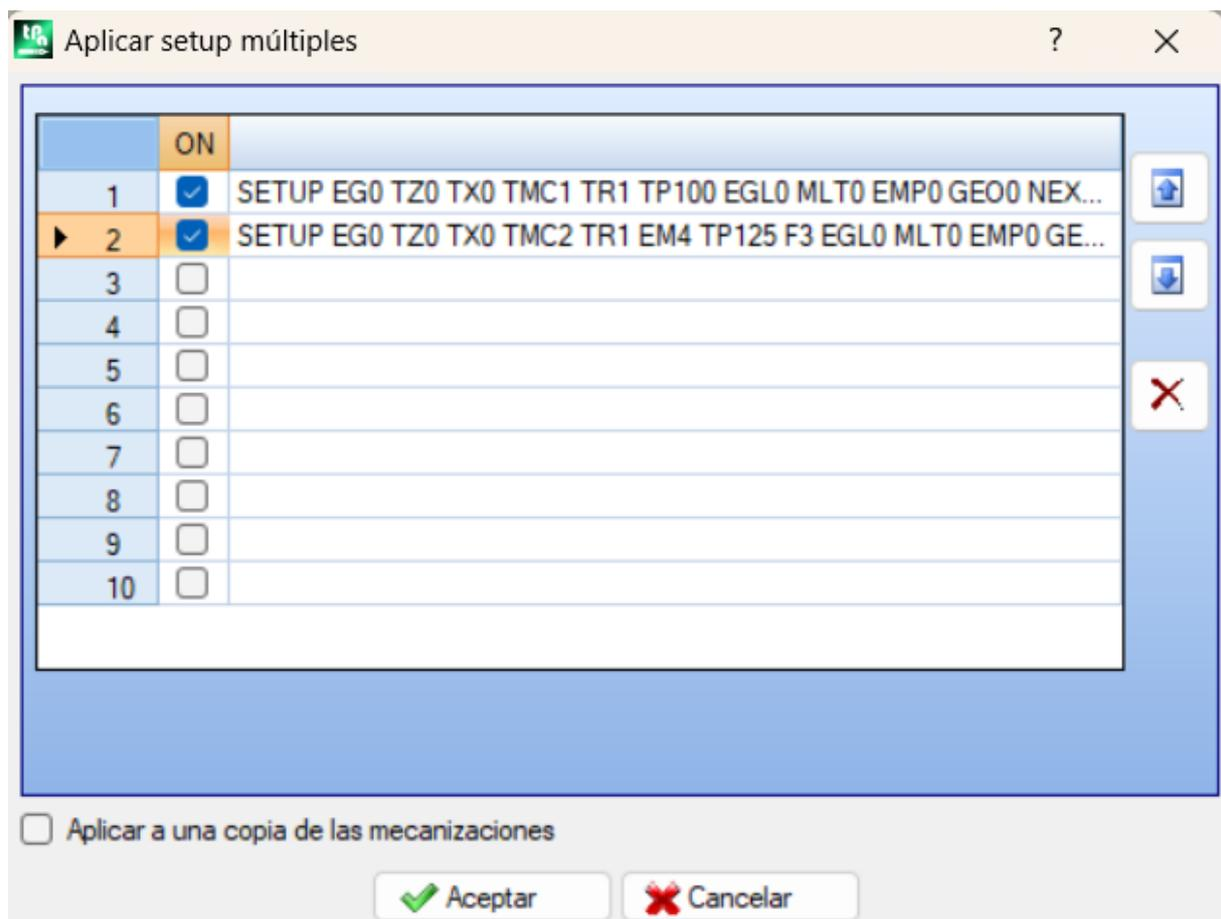
La ventana propone una tabla de 10 líneas. Cada línea puede asignar un setup con el mismo procedimiento examinado para la aplicación de un setup individual. Para habilitar un setup seleccionar la casilla correspondiente
