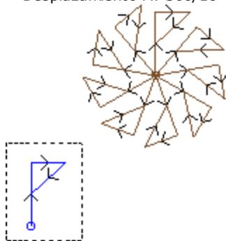
el cuadro evidenciado en figura corresponde al elemento individual, como programado en el subprograma. Todas las repeticiones son aplicadas en el punto de aplicación básica y giradas para que completen el ángulo giro.
