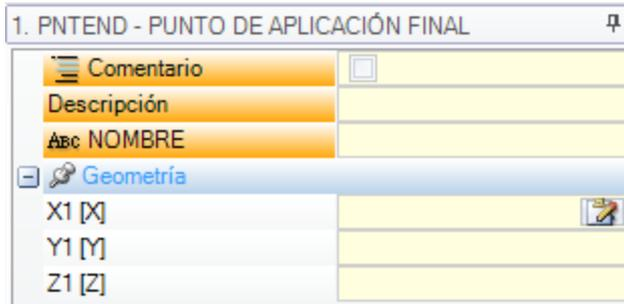
Los tres campos de X1,Y1, Z1 programan el punto de aplicación final que no tiene que coincidir necesariamente con las coordenadas de un punto de trabajo. La programación de las coordenadas es en modalidad absoluta y para las coordenadas no programadas es asunto valor 0.0.
