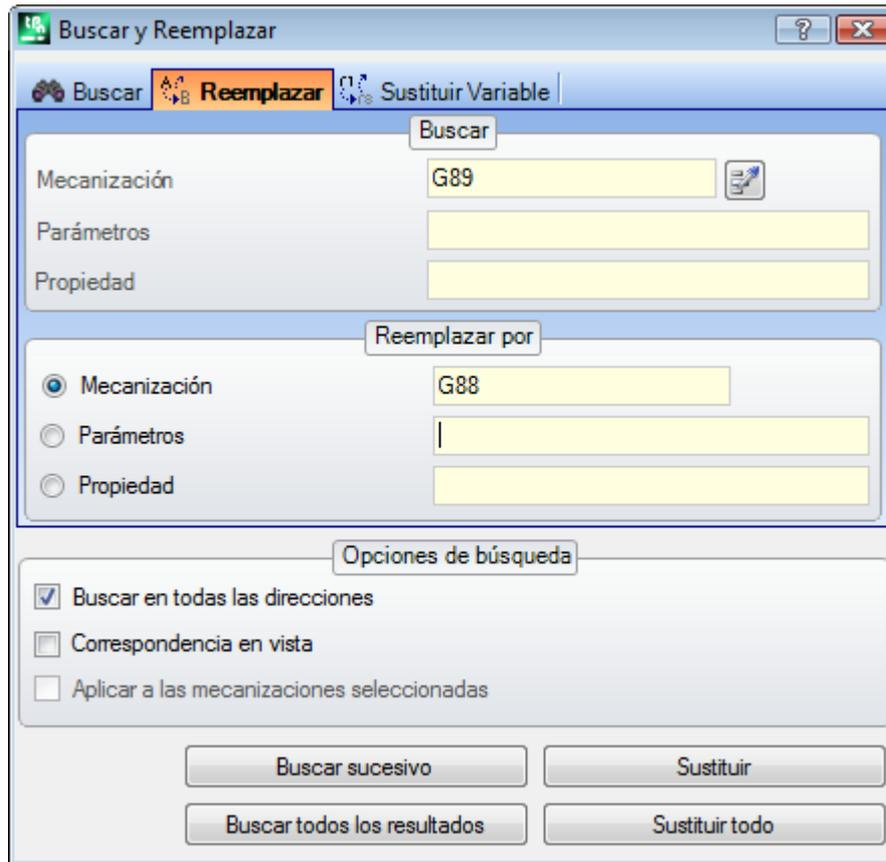
Supongamos de abrir un programa que utiliza códigos de mecanización no definidos o inválidos en la configuración actual del aplicativo (en el ejemplo: "G89" no corresponde a ningún código operativo de mecanización).
