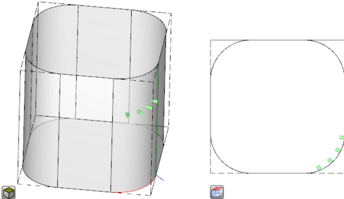
La programación de un setup orientado puede habilitar la modalidad de **Seguimiento tangente**, correspondiente a la solicitud de mantener el eje de la herramienta perpendicular durante la ejecución del perfil. Se utiliza esta modalidad para ejecutar fresados no verticales (el eje de la herramienta está paralelo al plano XY de la cara o inclinado, pero no perpendicular al plano XY) con la necesidad de mantener el eje de rotación de la herramienta perpendicular al perfil que se desea ejecutar.
