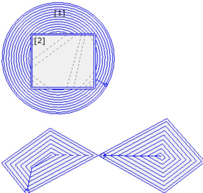
En figura está representado el vaciado de un círculo (1) con isla rectangular (2).
