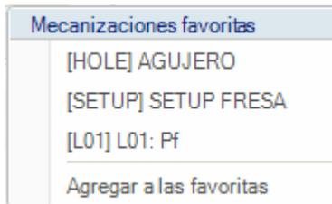
La lista de figura es un ejemplo: en construcción de programa es posible insertar mecanizaciones indicadas directamente en la lista, sin acceder a la paleta de las mecanizaciones.
