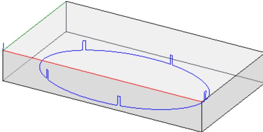
En aplicación de interrupciones, se suele utilizar la herramienta con tecnologías de corte que difieren de una herramienta tradicional, tales como: corte por plasma, láser o similares.
