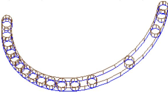
La visualización a tramo lleno puede resultar particularmente útil en caso de perfiles de vaciado, para evaluar la efectiva remoción del material. La figura explica la diferencia entre las dos representaciones.
