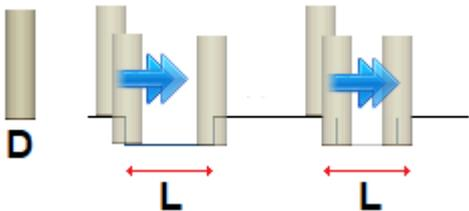
A la izquierda está mostrada una conexión realizada sin Compensación herramienta y a la derecha está mostrada la misma conexión con Compensación interna:
