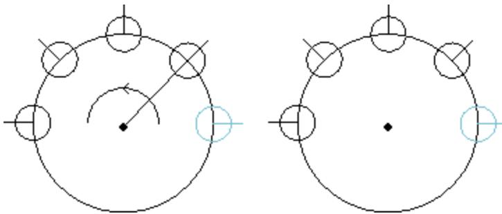
Repetición de la mecanización a tramo marcado por **5** elementos, ángulo que llenar: **180°**, en rotación en sentido contrario.
