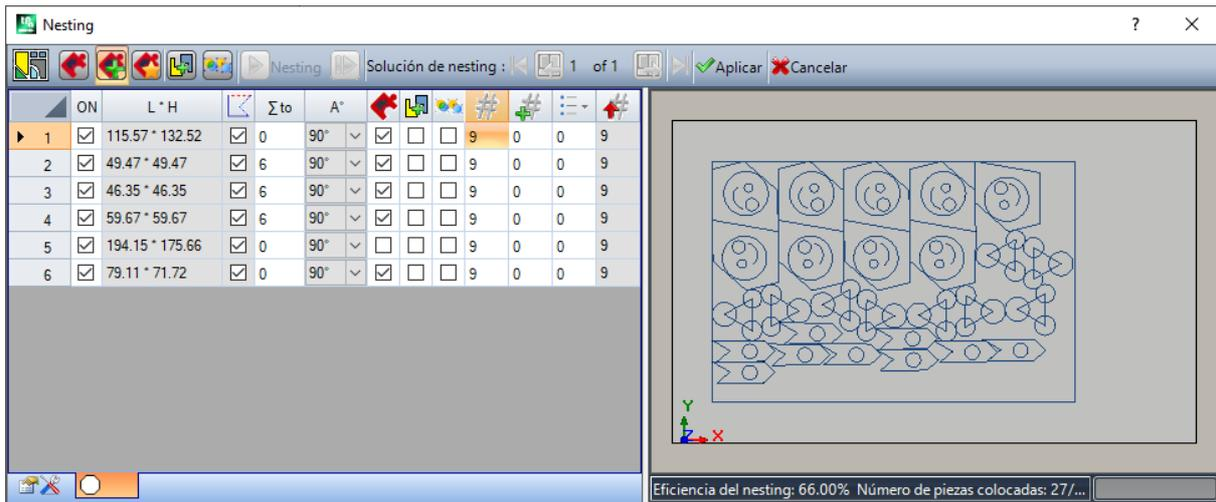
En la figura está resaltado el rectángulo que está asignado para el posicionamiento de los perfiles. Para cada grupo se hizo el posicionamientos de 9 copias, para un total de 27/27 colocaciones requeridas.
