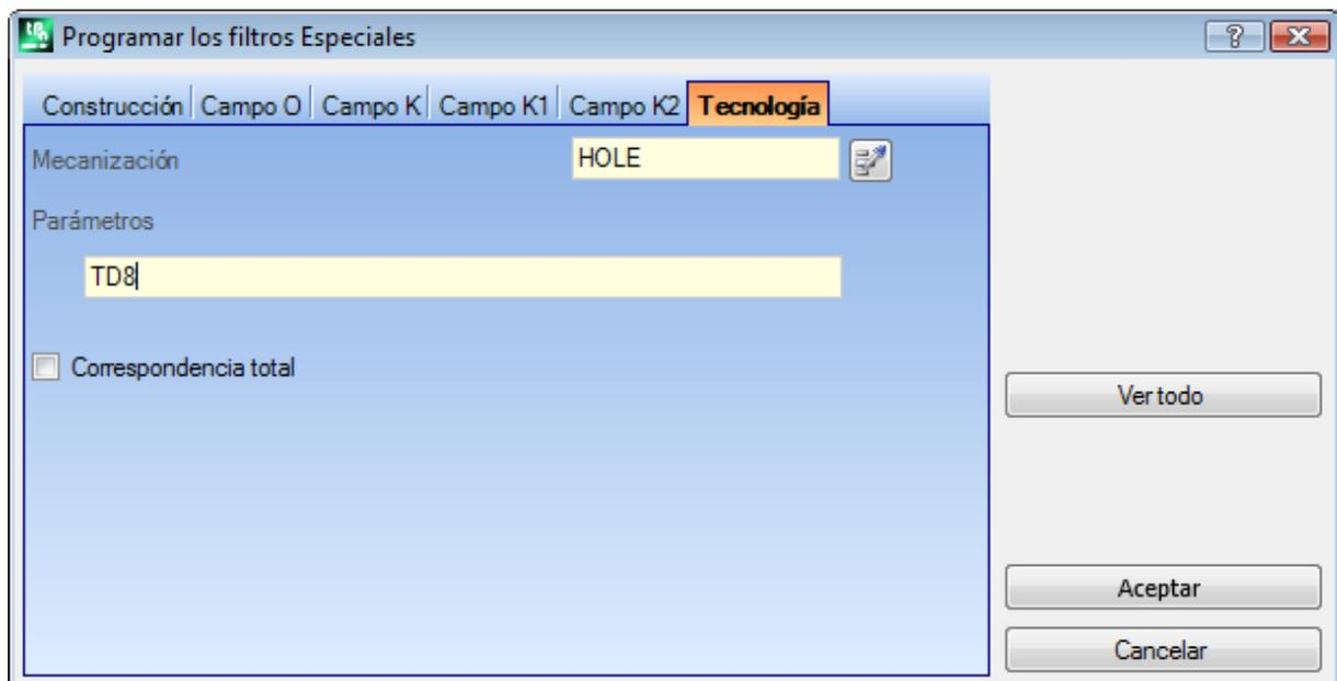
Según los datos programados en la ventana de ejemplo son visualizadas sólo las mecanizaciones con código ASCII "HOLE" y con parámetro TD a valor 8.
