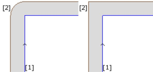
En la figura de izquierda el perfil correcto se mueve alrededor del vértice original con un arco de radio igual al radio de la herramienta; en la figura de derecha el perfil correcto sigue hasta el punto de intersección externo de los tramos lineales correctos.
