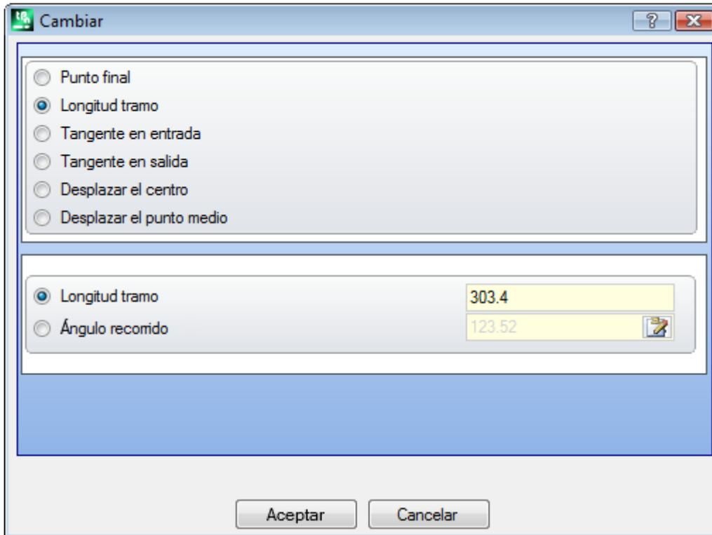
El cambio del tramo puede causar la modificación del código operativo de la mecanización actual. La herramienta no trabaja si la mecanización actual no verifica los filtros de vista activos (selecciones, condiciones lógicas niveles, filtros especiales) o bien si el perfil está en estado bloqueado (es una llamada inducida o bien tiene nivel, construcción o campo O bloqueado).
