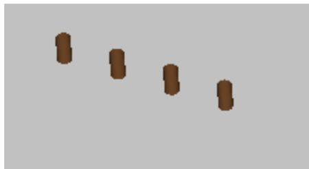
El dibujo muestra un ejemplo de representación tridimensional de mecanizaciones puntuales (o setups aislados), con habilitada la visualización de los espacios ocupados: para cada mecanización está representado un pequeño cilindro de altura igual a la profundidad programada. El relleno del pequeño cilindro se determina mediante la selección **Visualizar el espacio ocupado de puntos y setup a tramo lleno**. La predeterminación no está habilitada.
