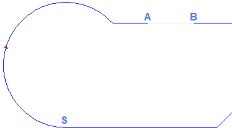
En el perfil han sido indicados 2 puntos de corte: (A) y (B) (los dos puntos pueden caer sobre el mismo tramo o sobre tramos distintos). La parte de perfil incluida entre los dos puntos es eliminada (**ATENCIÓN**: en el sentido de recorrido original)
