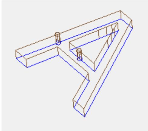
El dibujo enseña un ejemplo de representación tridimensional de perfiles, con habilitada la visualización de los espacios ocupados: cada tramo de perfil marca el espacio ocupado de la herramienta dentro de la pieza. El valor predeterminado está inhabilitado.
