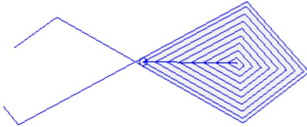
En figura hay representado el vaciado de un perfil que no está cerrado: la comprobación para el vaciado se ejecuta según la existencia de áreas cerradas.
