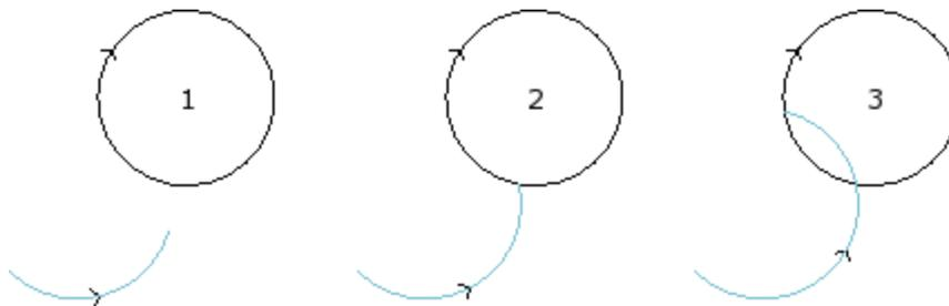
El arco representa el tramo que debe ser extendido hasta el punto de intersección con el círculo
