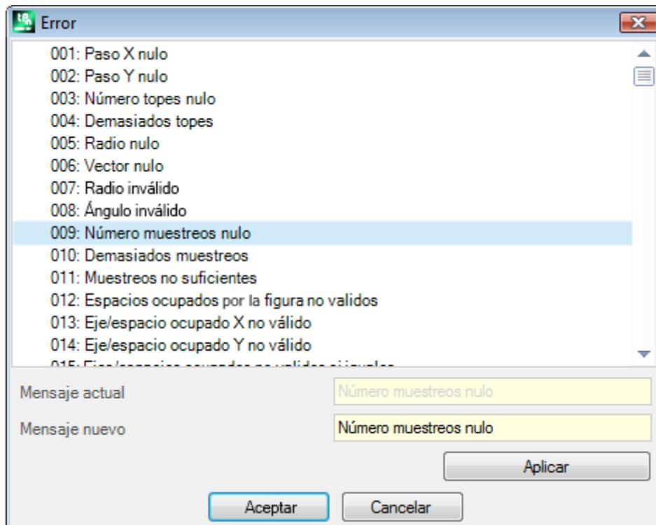
A nivel constructor es posible insertar un nuevo mensaje o modificar uno existente. Después de la selección del mensaje de cambiar o insertar, la modificación tiene que ser escrita en campo de edición **Mensaje nuevo**. Para confirmar la introducción del mensaje, presione la tecla **[Aplicar]**.
