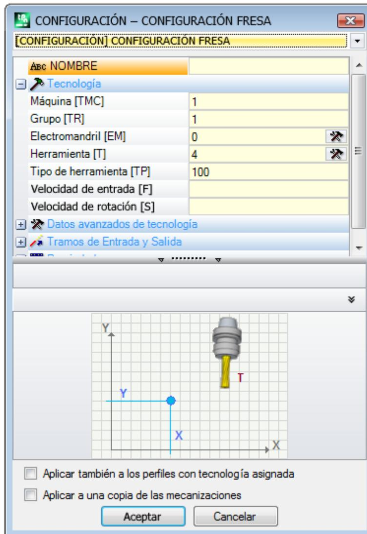
En la ventana se selecciona antes de todo el código de setup que asignar, entre los en lista (en figura: [SETUP] SETUP FRESA) y la lista de los parámetros se actualiza con los datos relativos a la mecanización seleccionada. Configure entonces los parámetros tecnológicos y las propiedades de la mecanización y confirme con la tecla **[Aceptar]** para aplicar la asignación.
