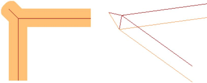
Como es evidente por la figura, la nueva subida en el vértice está añadida sobre la "parte externa" del perfil. En un perfil rectangular es intuitivo localizar la parte externa, pero no es siempre así. Un perfil puede tener partes cóncavas y partes convexas, puede también ser cerrado o no. Por todas estas razones, al campo **Corte con aristas vivas** se asocian cuatro posibles elecciones:
