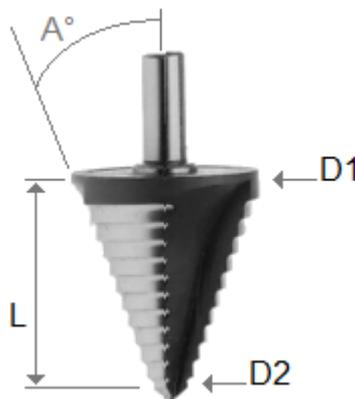
caracterizado por dos diámetros extremos y por el ángulo del cono. La herramienta cava el material según la sección que está sujeta: mayor es la profundidad programada y mayor es el diámetro que trabaja sobre la superficie de la pieza.
