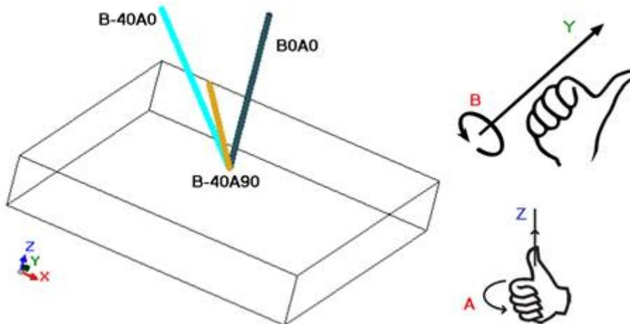
En una mecanización de setup que asigna la orientación de la herramienta, las cotas XYZ asumen un significado notable, con respecto al caso de setup no orientado.
