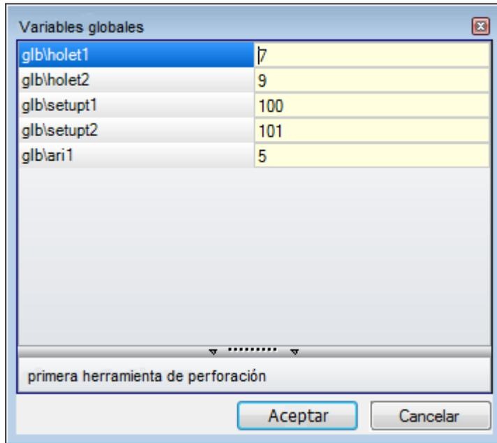
La tabla puede mostrar hasta 300 variables máximo de tipo numérico y solo se pueden llamar por nombre simbólico, con el formato: "glb\xxx" con "xxx" = nombre simbólico. Las variables se asignan en configuración de TpaCAD y se pueden utilizar para cada configuración.
