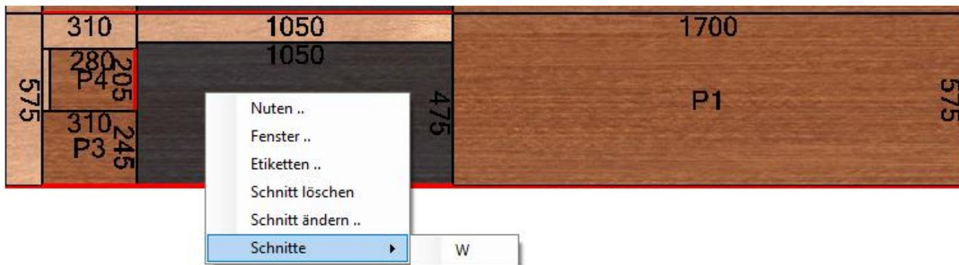
Nach Auswahl des Schnittcodes öffnet sich ein Fenster, in dem Sie die Abmessung der Positionierung des Schnittes und der Wiederholungen eingeben können. Der in diesem Bereich verfügbare Höchstwert wird ebenfalls angezeigt. Diese Grenze berücksichtigt den Wert der im Schnittbereich eingestellten Schnitt, falls vorhanden.
